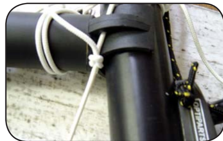
Un nudo llano para ayudar a ajustar el contravang.
