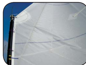
Tensión correcta. Una pequeña arruga perpendicular al pico está bien.
