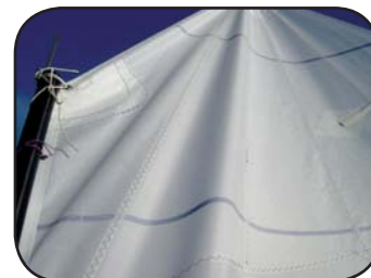
Demasiada arruga, demasiada tensión en el pico.
