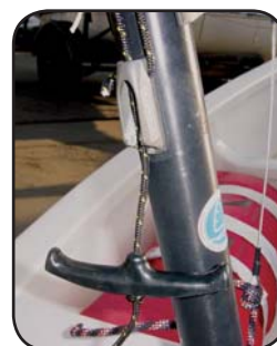
Manija atada en el aparejo de pico te ayudará a ajustar el pico durante la navegación.
