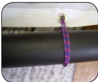
No más de 1 cm de separación entre la vela y la botavara.
